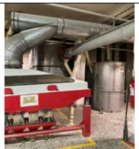
Fotografía No. 9 Molino de maíz, y silo de la primera humectación en el segundo nivel.
